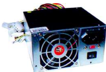
Fuente ATX Conector 20 pines
